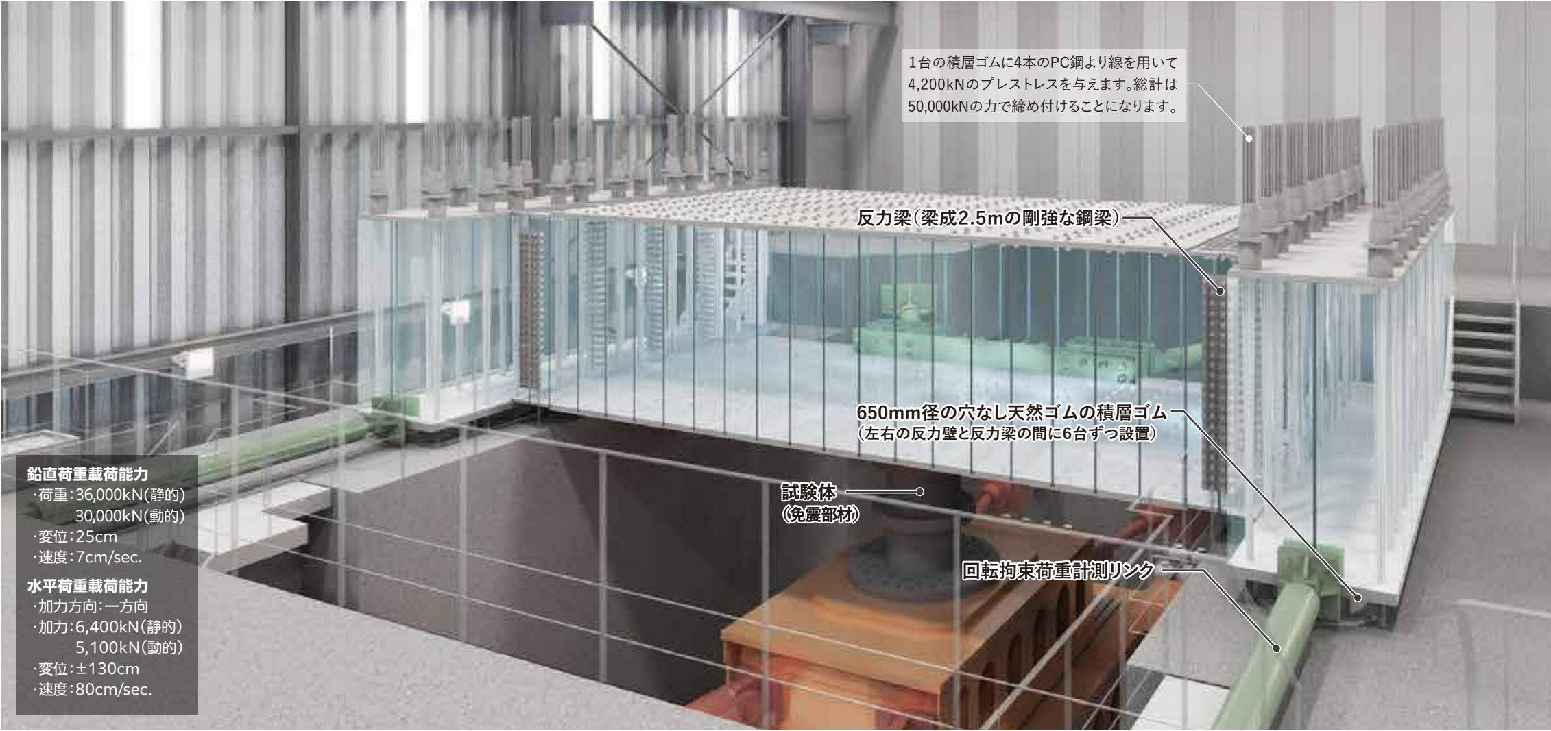
実大免震試験機
