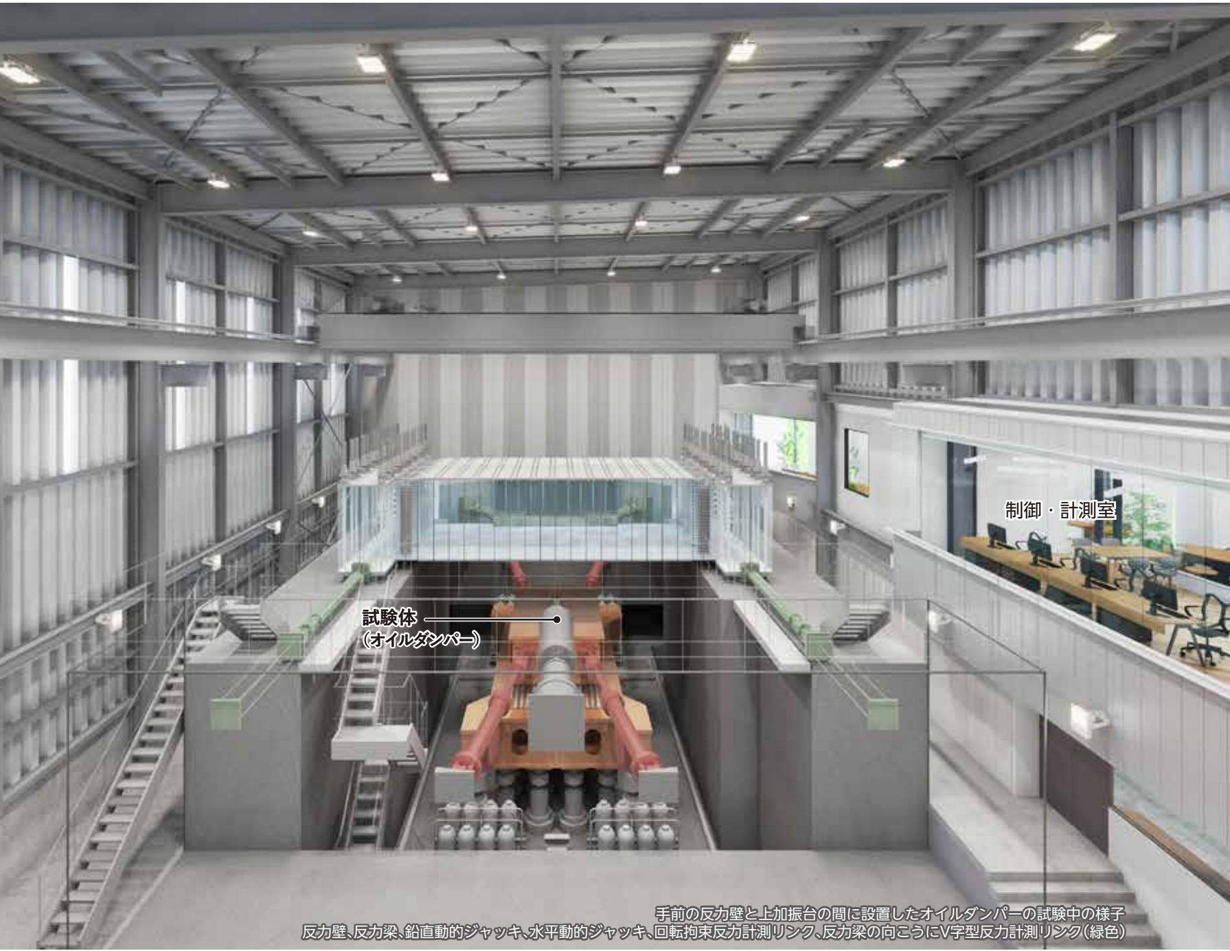
手前の反力壁と上加振台の間に設置したオイルダンパーの試験中の様子 反力壁、反力梁、鉛直動的ジャッキ、水平動的ジャッキ、回転拘束反力計測リンク、反力梁の向こうにV字型反力計測リンク(緑色) 実大免震試験機に面し、近接した位置に試験機の制御・計測室を計画。動的载荷を受ける試験体を直接観察することができます。
