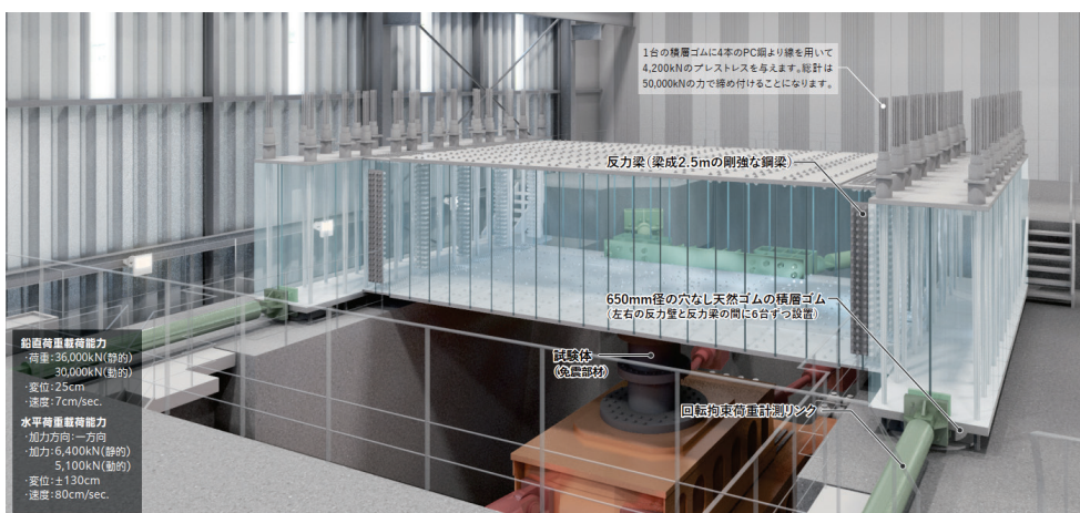
図 4 実大免震試験機の完成パースと諸元
