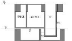
図4 1階吊り床部断面図
